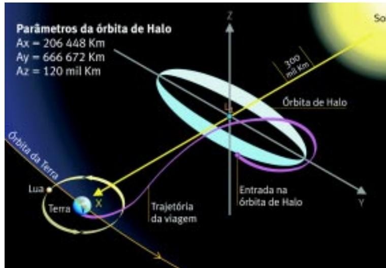
Figura 4. Vista da Terra, uma órbita do tipo halo no ponto L1 contorna o disco do Sol, evitando que as radiações solares interfiram nas comunicações com um satélite ali colocado
